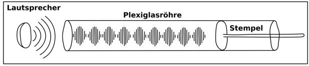
Die Luftsäule im Innern des Rohrs gerät in Resonanzschwingungen.
